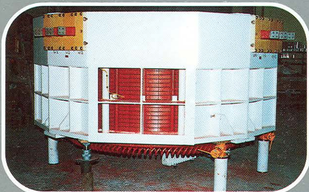
STATOR OF POWER - PLANT «GIONA»
